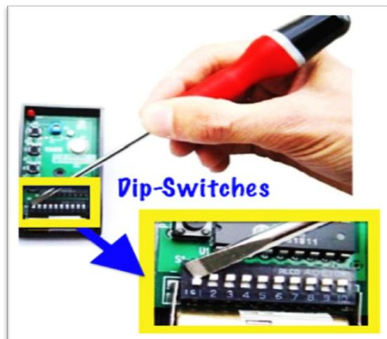
Im Inneren Ihrer Fernbedienung finden Sie Mini-Schalter, auch "Dip-Switches" genannt. Damit sie korrekt funktioniert, müssen Sie auf folgende Weise einen Code eingeben:
