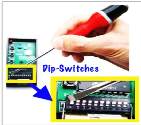
Im Inneren Ihrer Fernbedienung finden Sie Mini-Schalter, auch "Dip-Switches" genannt. Damit sie korrekt funktioniert, müssen Sie auf folgende Weise einen Code eingeben:
